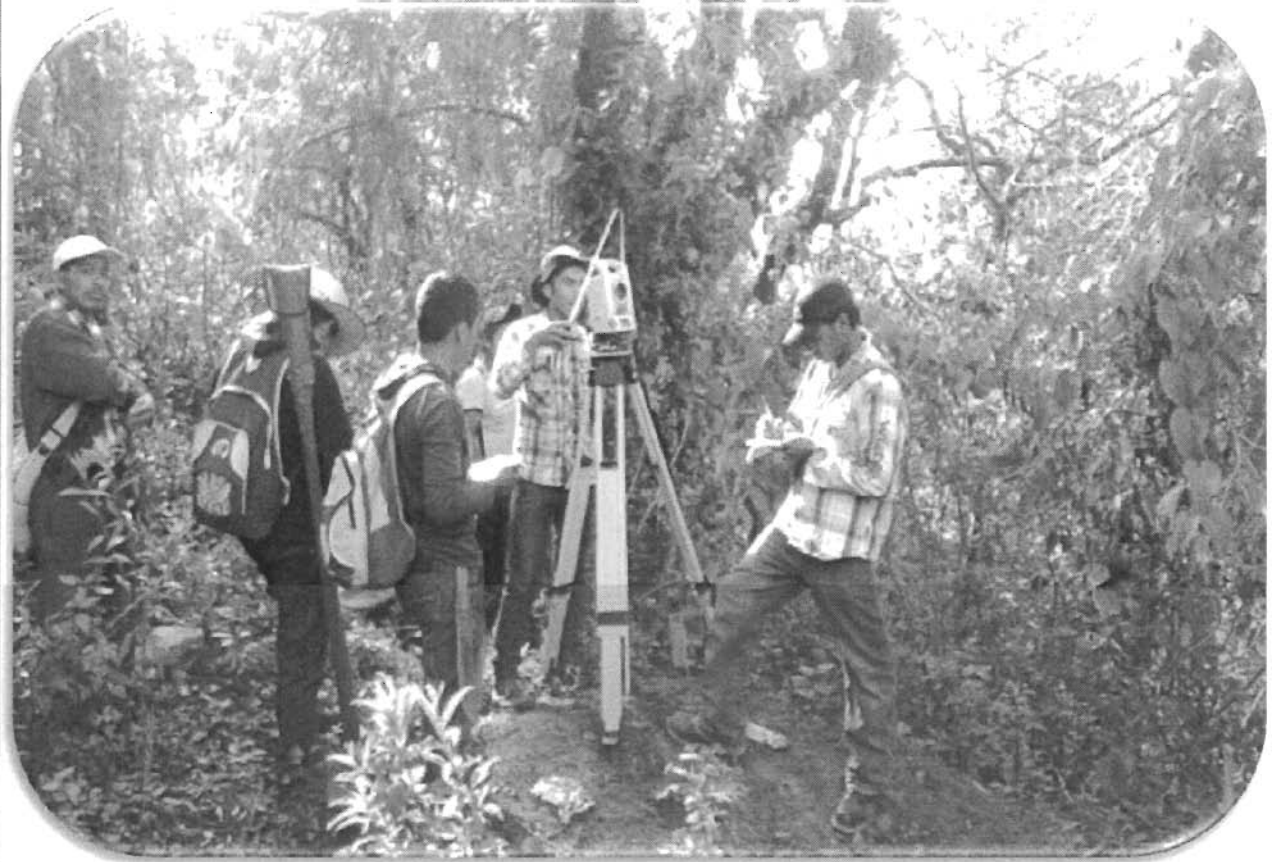
Levantamiento topográfico Proyecto Siete Platos.
